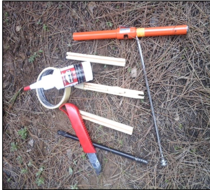
Figure 6 : Matériel utilisé (Tarière de PRESSLER, cutter, réglottes, colle, ruban adhésif) (2018)
