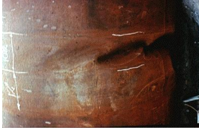
Figure II.8 : Flambement d'une coque cylindrique comprimée.
