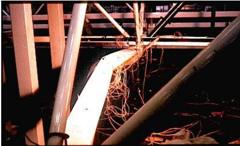
Figure II.6 : Ruine locale d'un profil creux rectangulaire.
