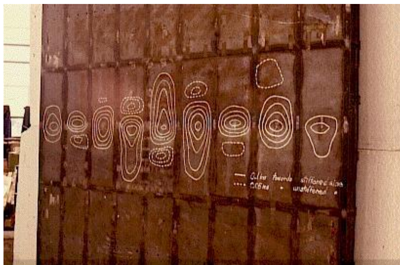
Figure II.4 : Flambement d'une plaque raidie.
