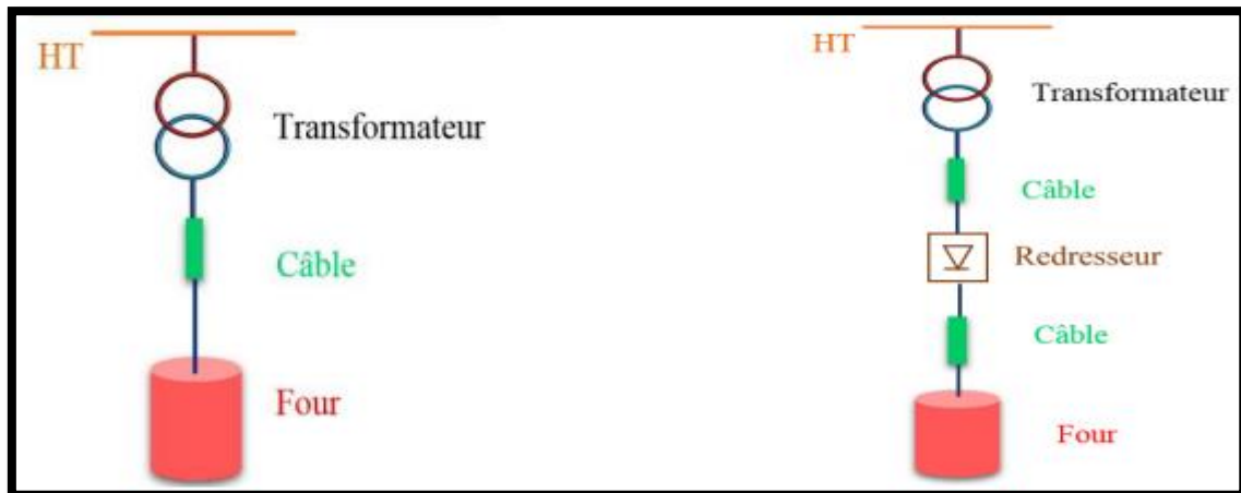
Figure II.8.(a). : Le four à arc alimenté en courant Alternatif et (b). Le four à arc alimenté en courant continu [24]
