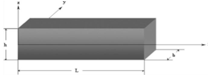
Fig (3.1) Géométrie de la poutre FGM.
