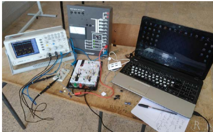
Figure III- 14 : Test pratique du deuxième schéma de la pompe de charge de Dickson
