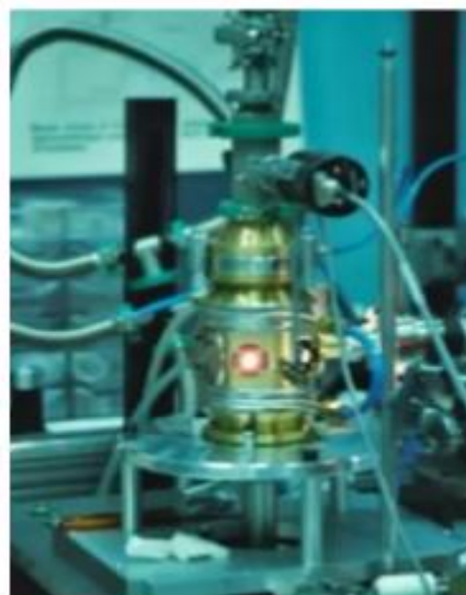
Figure I.13 : Schéma de l'appareillage d'ablation laser.
