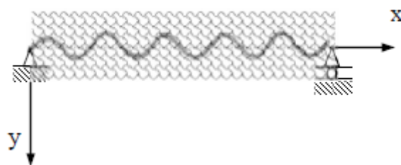
Figure IV.1: Vibration transversale d'une poutre située dans un milieu élastique.
