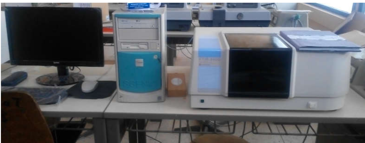
Figure II-17 : Spectroscopie Infrarouge de marque Alpha Bruker (FTIR-8400 ).
