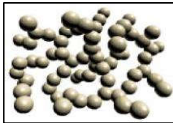
Figure II-3 : Structure d'un aérogel.
