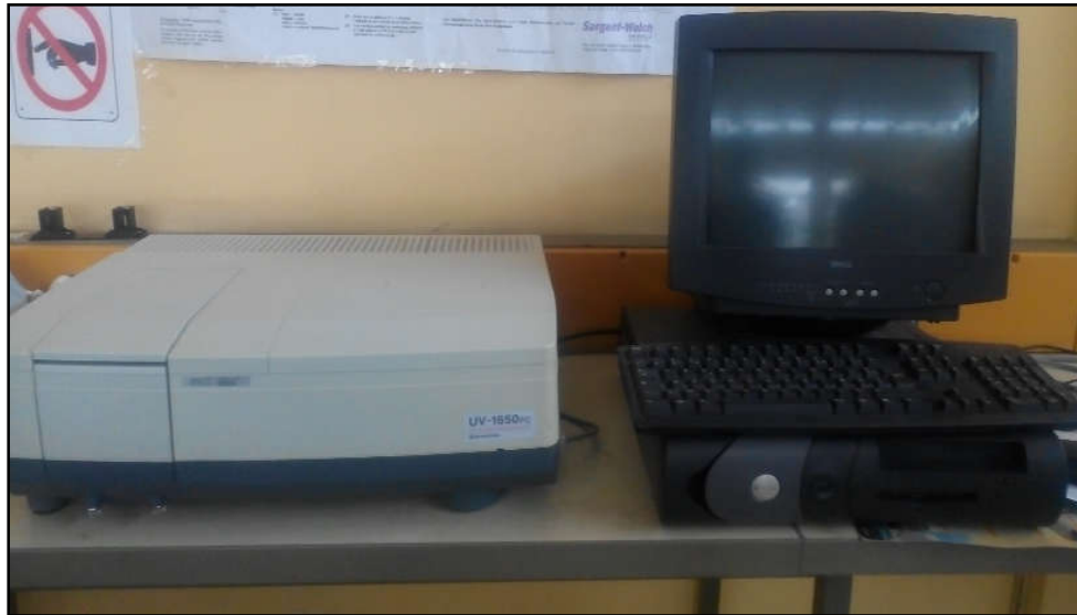
Figure II-22 : Spectrophotomètre UV-Visible de marque SHIMADZU UV1650 pc à double faisceaux.
