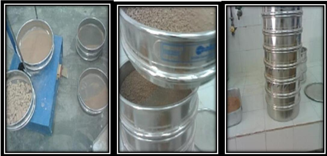
**Figure III.13 : Essai d'analyse granulométrique déchets de brique**
