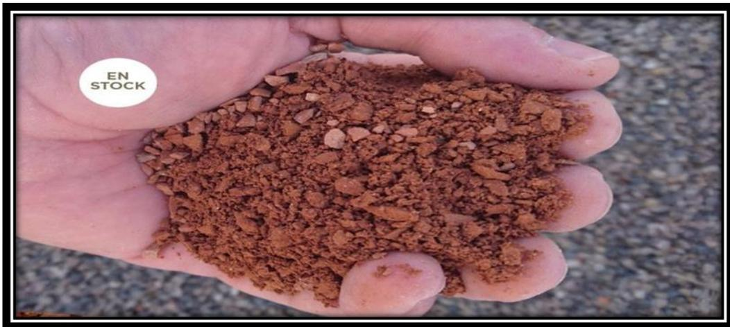
**Figure I.6 : Echantillon de Sable concassé (Artificiel)**
