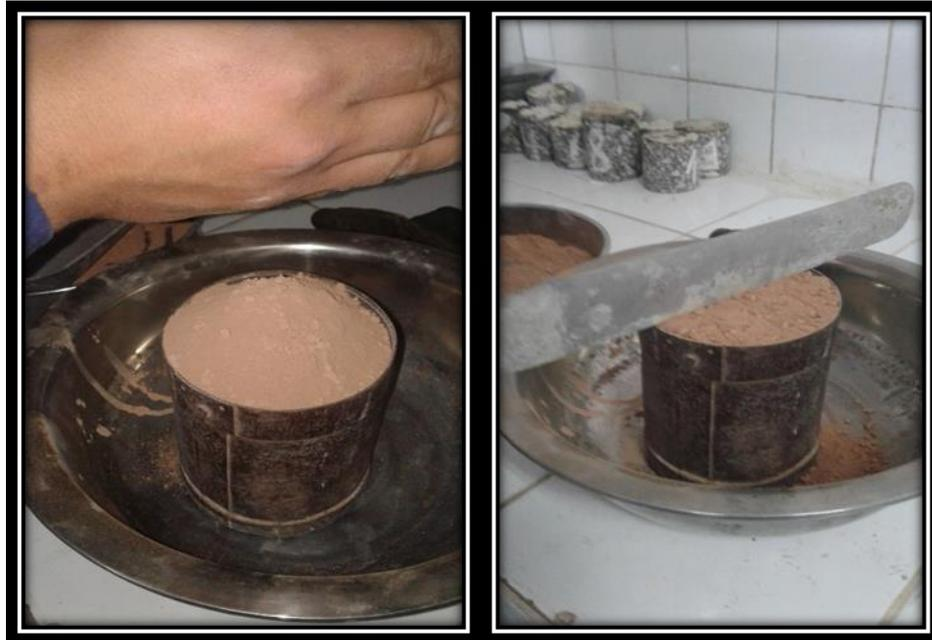
**Figure III.14 : Essai déterminer la masse volumique apparente de déchets de briques**
