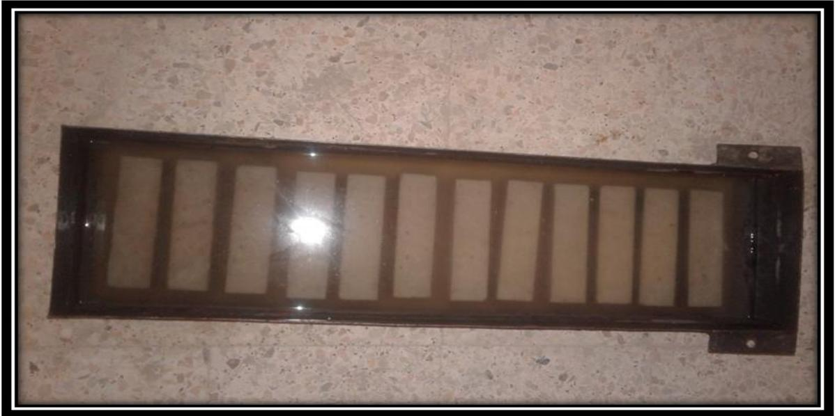
**Figure III.25 : Eprouvtes de mortier témoin conservé dans l'eau de robinet (pH=7)**
