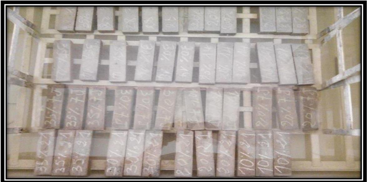
**Figure III.26 : Conservation des éprouvtes des mortiers substitués avec différent pourcentages de déchets des briques dans l'eau**
