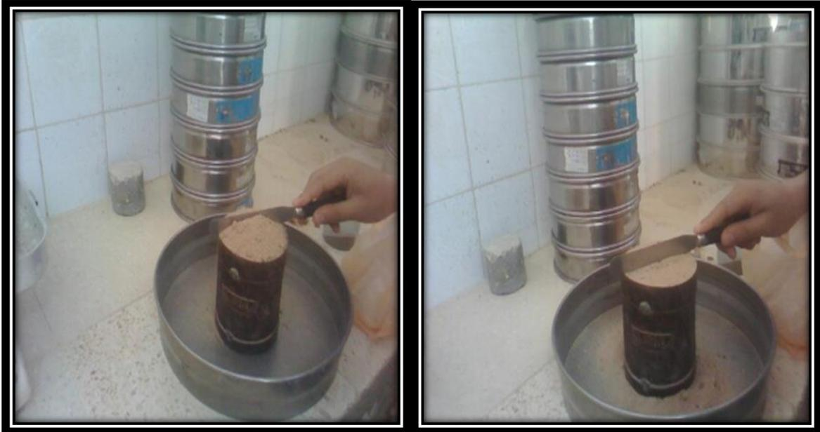
**Figure III. 10 : Essai de la masse volumique apparente**
