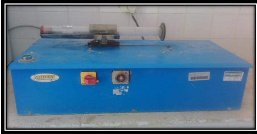
**Figure III.8 : Machine d'agitation des sables (mouvement horizontale)**
