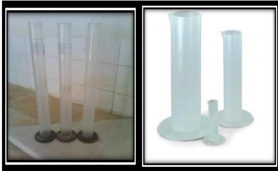
**Figure III.9 : Eprouvettes pour essais d'équivalent de sable**
