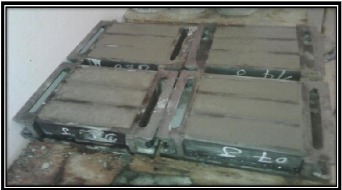
**Figure III.23 : Préparation des éprouvettes prismatiques (40 x 40 x 160)**
