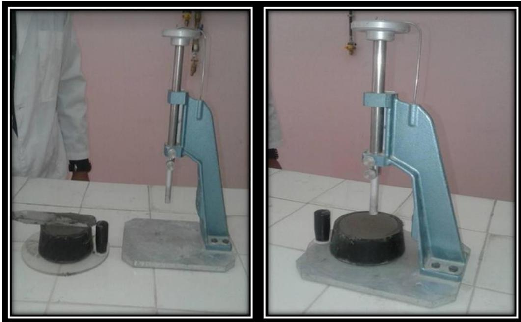
**Figure III.4 : Appareil de Vicat**
