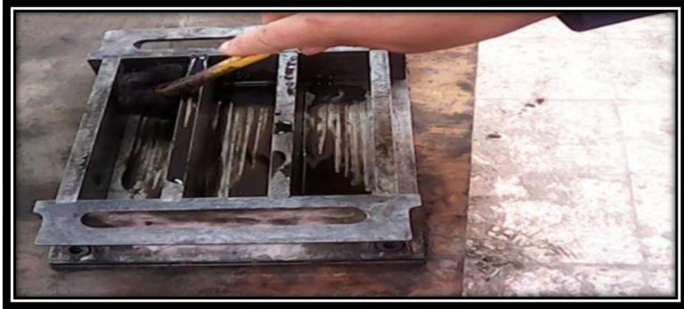
Figure III.18 : Préparation des moules (couche de huile)
