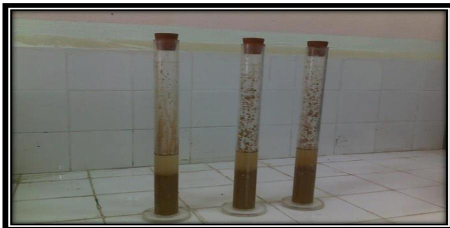
**Figure III.7 : Essais d'équivalent de sable**
