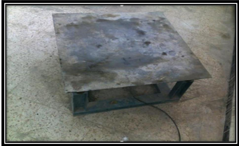
**Figure III.22 : Table de chocs pour les éprouvettes**
