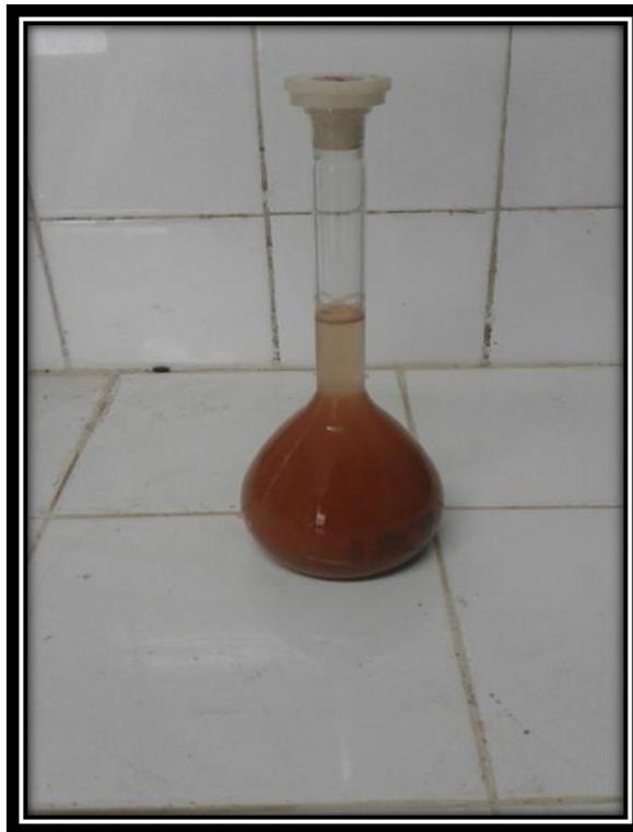
**Figure III.15 : Détermination de la masse volumique absolue de déchets de brique**
