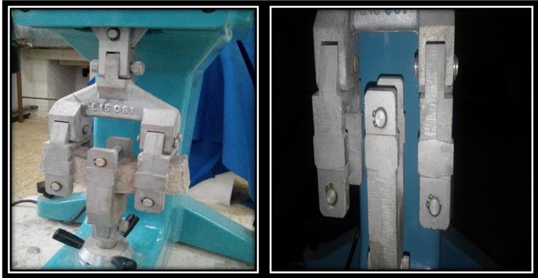
Figure III.27 : Dispositif pour l'essai de résistance à la flexion
