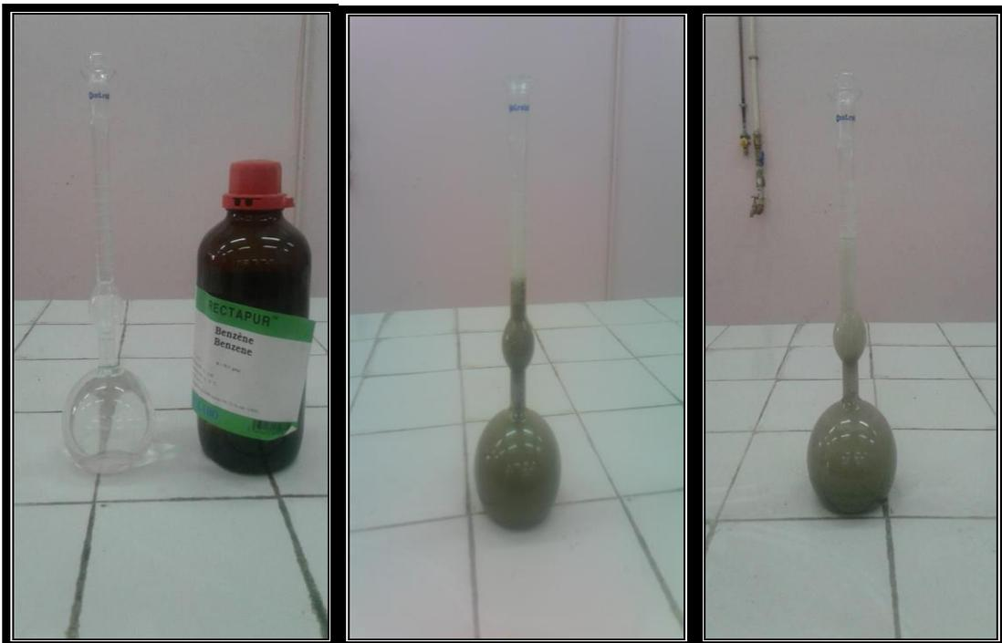
**Figure III.3 : Détermination de la masse spécifique du ciment**
