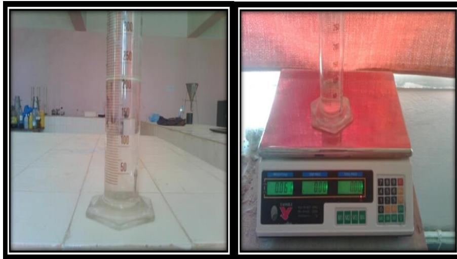
**Figure III.16 : Eau de gâchage (épreuve gradué)**
