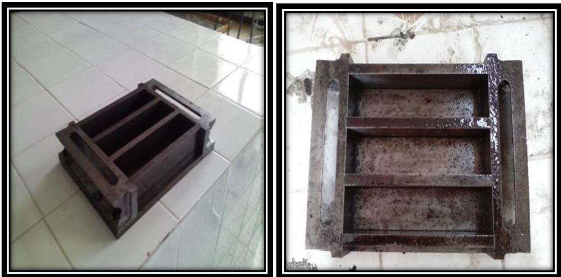
**Figure III.17 : Eprouvette prismatique (40 x 40 x 160)**
