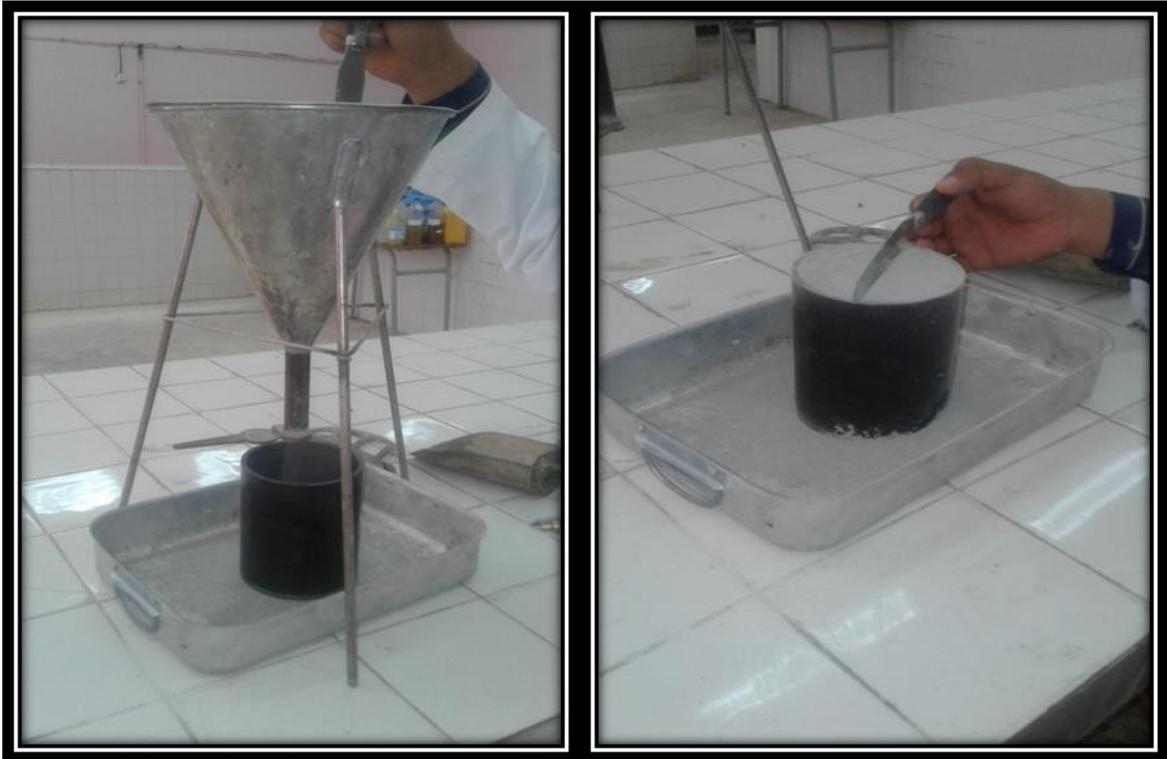
**Figure III.2 : Détermination de la masse volumique du ciment**
