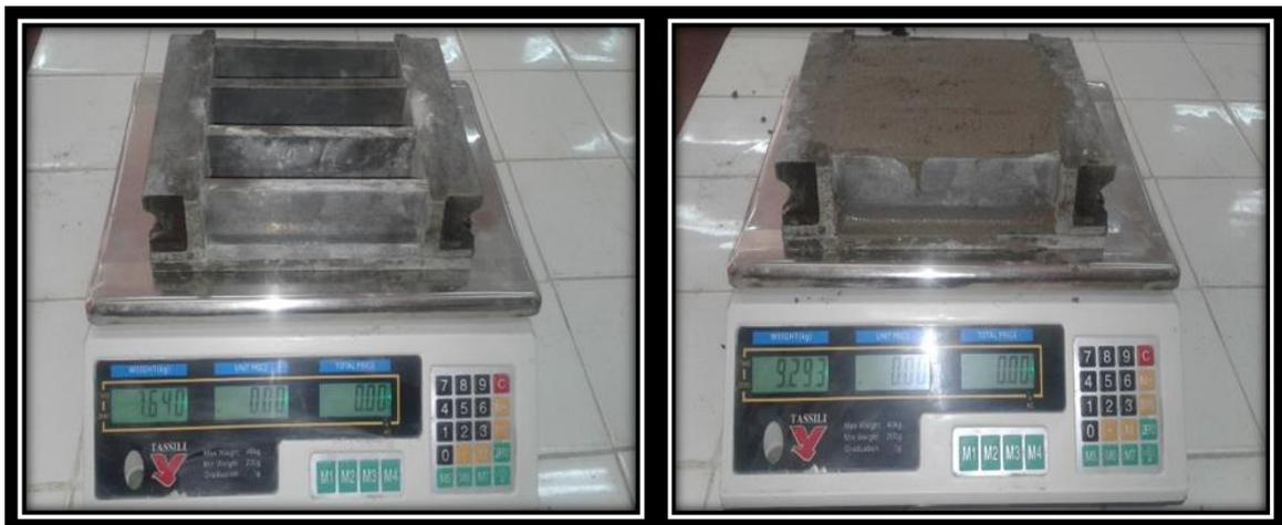
**Figure III.24 : Essais sur la masse volumique de mortier**
