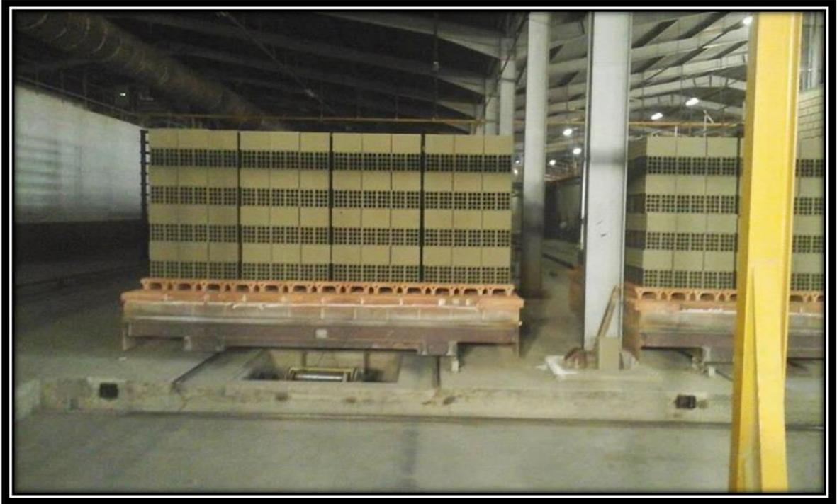
**Figure II.6 : Séchages des briques**
