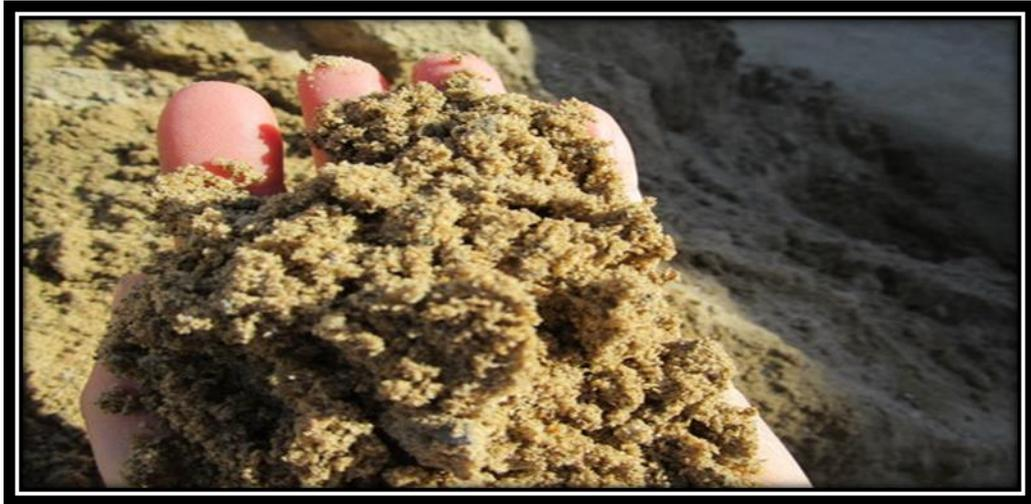
**Figure I.5 : Echantillon de Sable roulé (naturel)**
