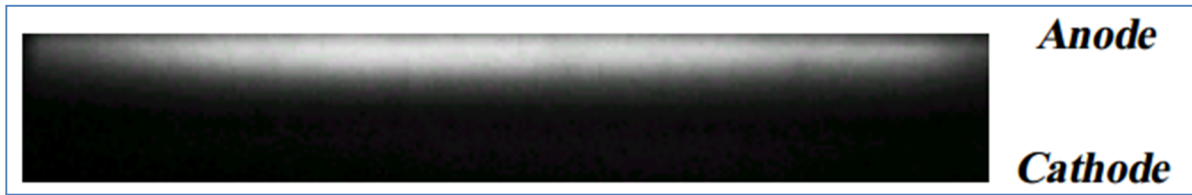
Fig.I.8 : Photographie d'une décharge de Townsend dans l'azote. [14]
