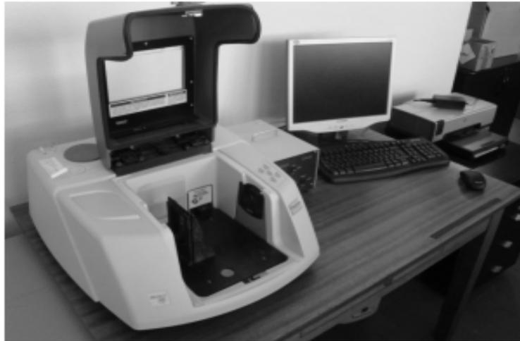
**Figure III.2 Spectromètre infrarouge avec dispositif de mesure en transmission pour céramique.**
