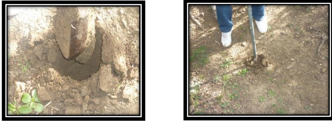
**Figure 13** : Prélèvement du sol à l'aide d'une tarière pédologique
