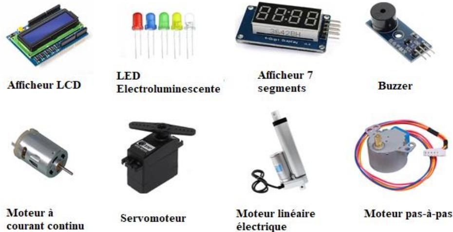
Figure I.5 Liste de quelques circuits de sorties
