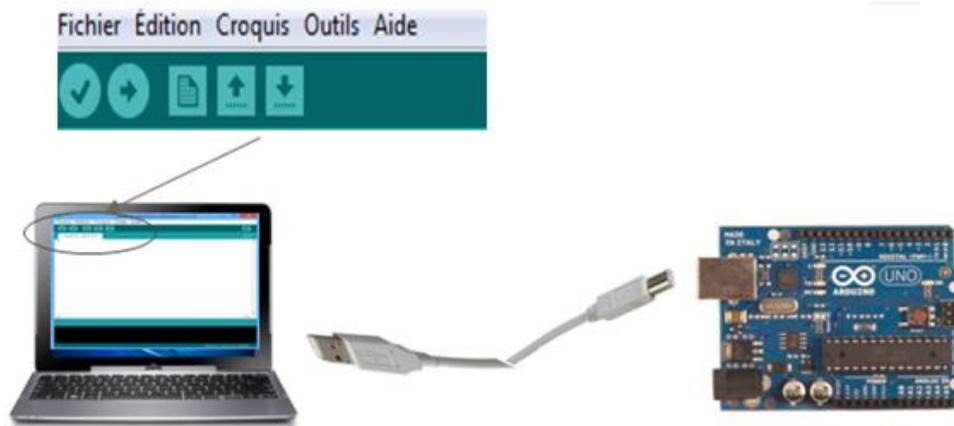
Figure II.9 Schéma de téléversement.
