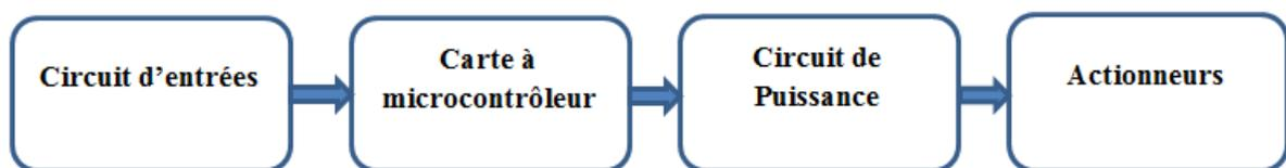
**Figure III.8** Schéma synoptique avec carte Arduino.
