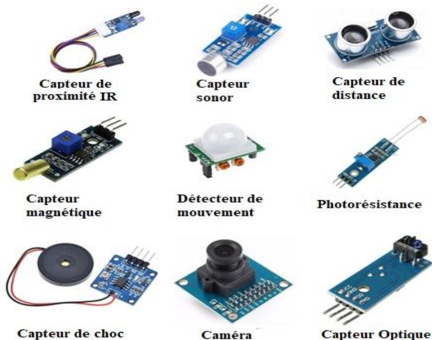
**Figure I.3** Liste de quelques circuits d'entrées
