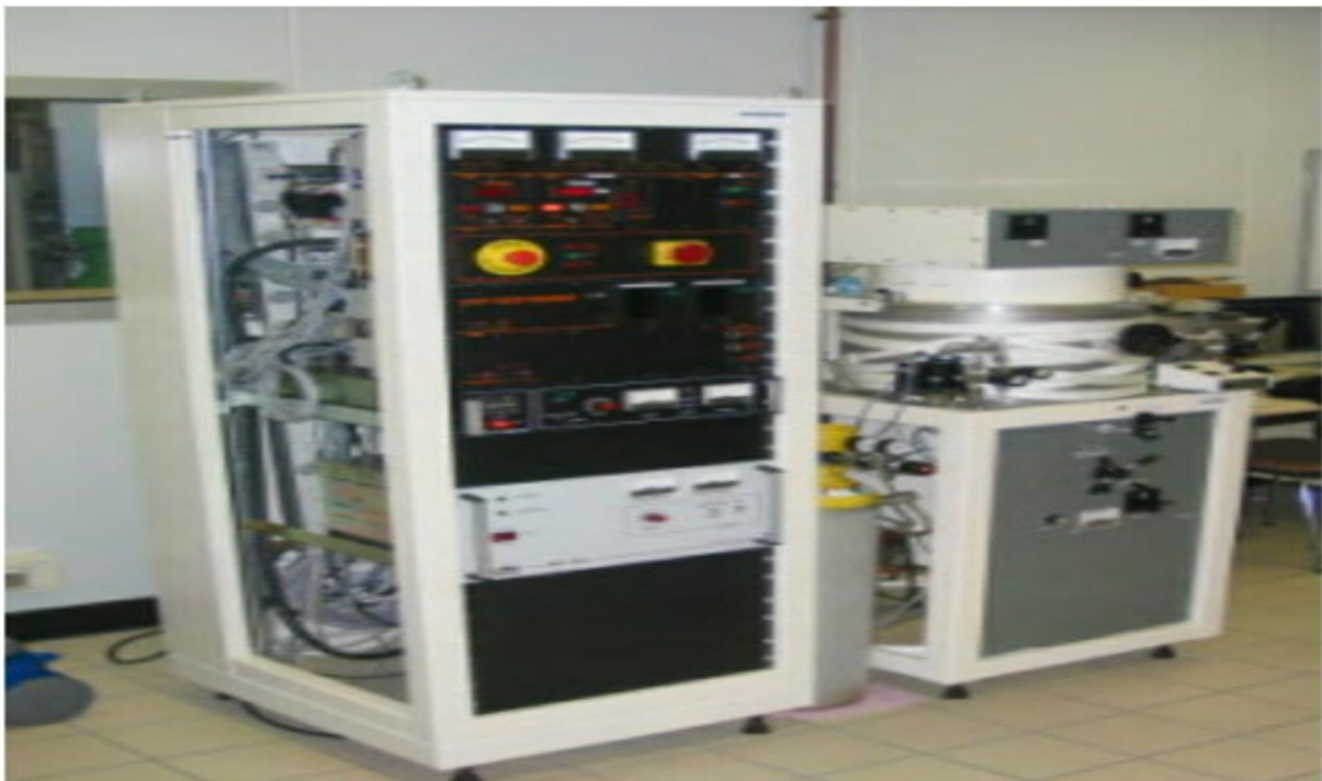
Figure 2.3 : Bâti de pulvérisation cathodique ALCATEL CIT (modèle A450). [27]
