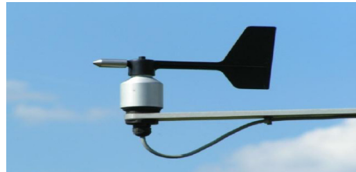
Figure. I.9: Girouette pour indiquer la direction du vent.
