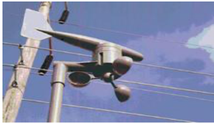
Figure. I.8: Anémomètre à coupelles sur son mât.
