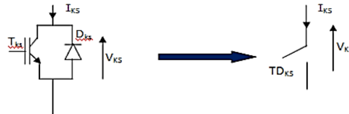
Figure .IV.2-a : Interrupteur bidirectionnel équivalent à une paire Transistor–diode
