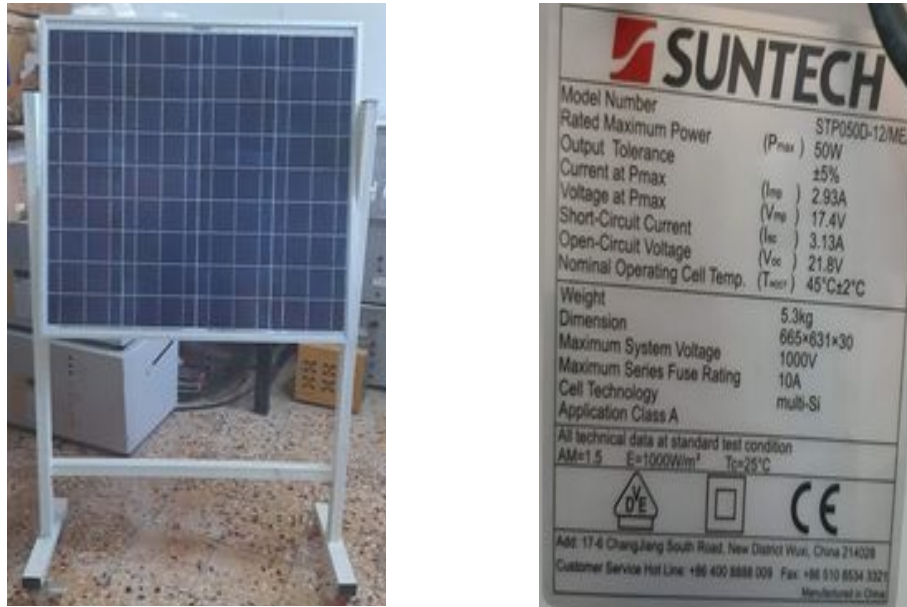
Figure III. 1: Panneau Photovoltaïque utilisé.
