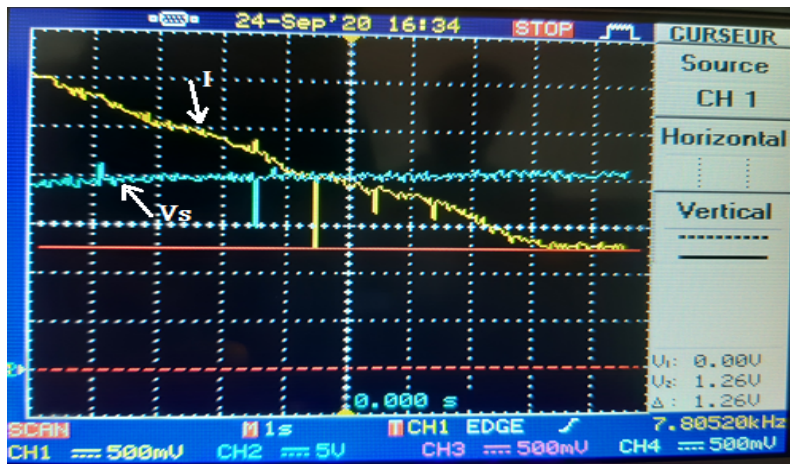
Figure.III.40: Caractéristique V_s (CH2) et I (CH1) dans les conditions ( T=25^{\circ}C et G=350w/m^2 ) Echelle: CH1 : 500mV/0.33A . CH2 : 5V/5V .
