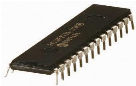
Figure 27: Un microcontrôleur PIC16F8734
