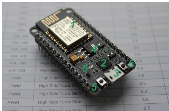
Figure 32: Composantes d'un NodeMCU
