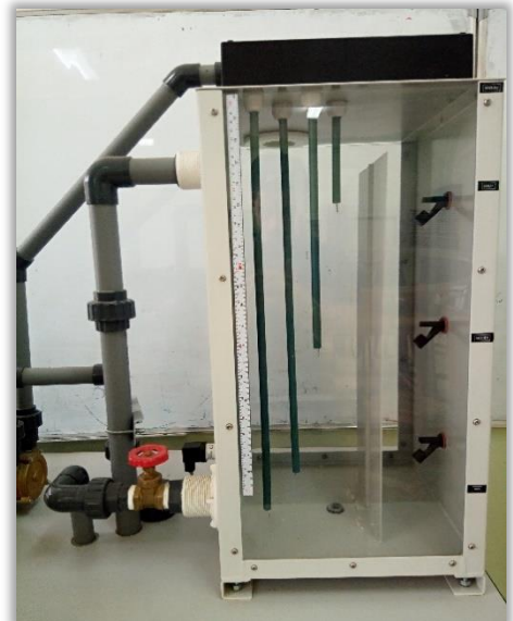
Figure I.5 cuve supérieure de 60L
