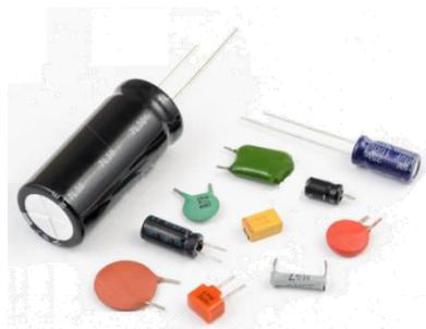
Figure III.12: Les condensateurs
