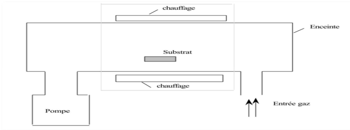
Figure II-13: Schéma de principe de dépôt en phase vapeur chimique (CVD), réacteur à parois chaudes.
