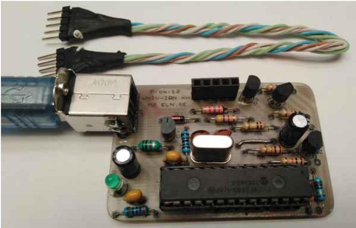
FIGURE 3.11 : Version finale du programmeur PICKit2 (version maison)
