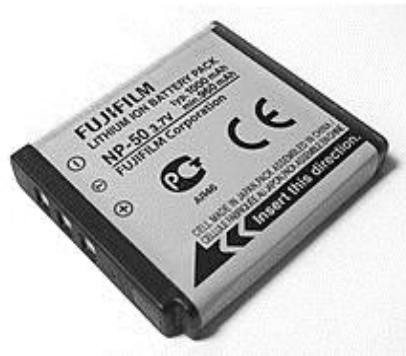
Figure I. 17 : Batterie au lithium ion
