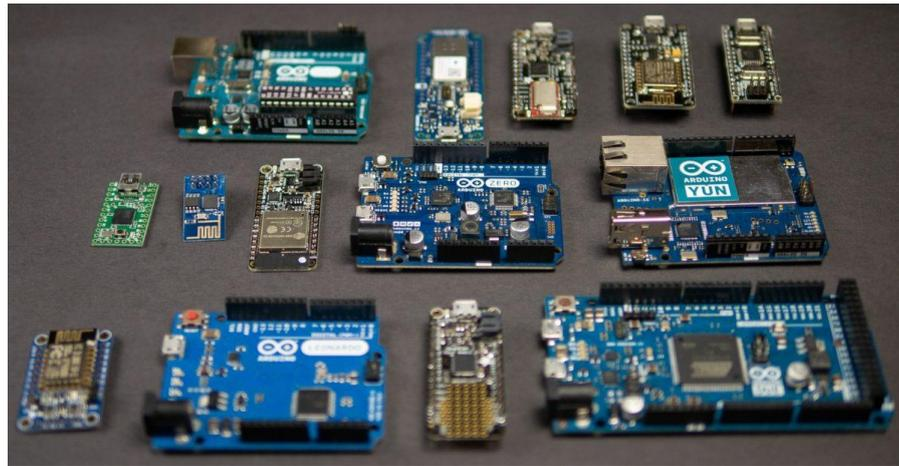
Figure 1.5 Exemple de cartes de développements électroniques à base de microcontrôleurs
