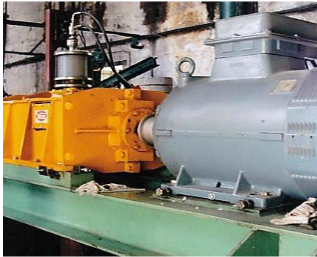
Figure I.6 : Génératrice asynchrone de 220 kW et son multiplicateur[16]
