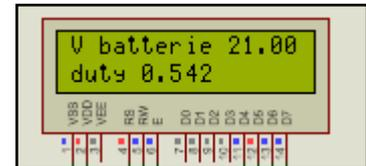
**Figure III- 28:** Tension de commande et de sortir du circuit chargeur de batterie (le panneau solaire de 21V)
