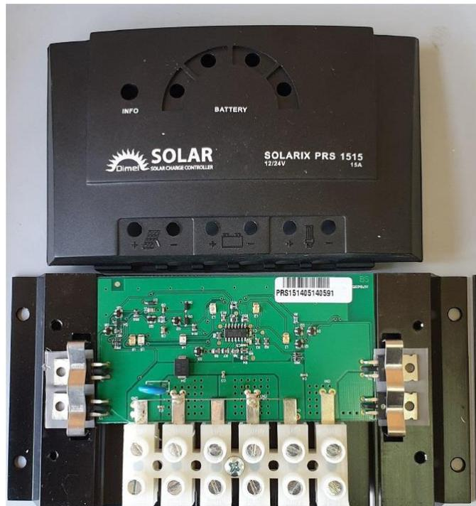
Figure III- 12: Boitier de régulateur de charge solaire Solarix PRS 1515
