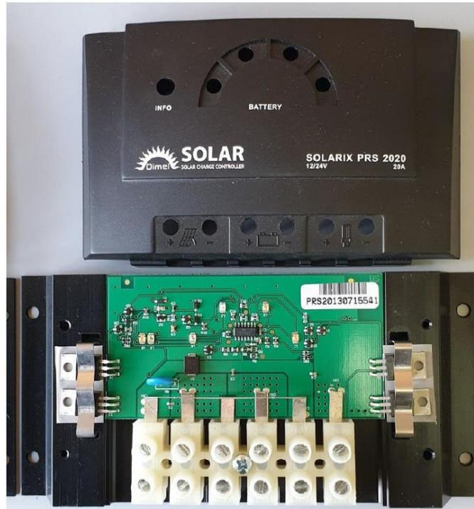
Figure III- 7: Boitier de régulateur de charge solaire Solarix PRS 2020
