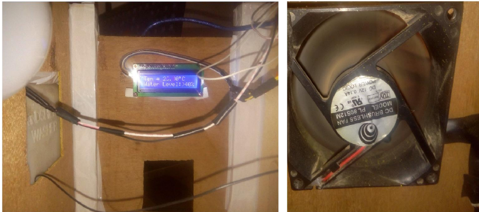
Figure V. 6 Photos de la phase de réalisation des fonctions d'acquisition de température et la ventilation
