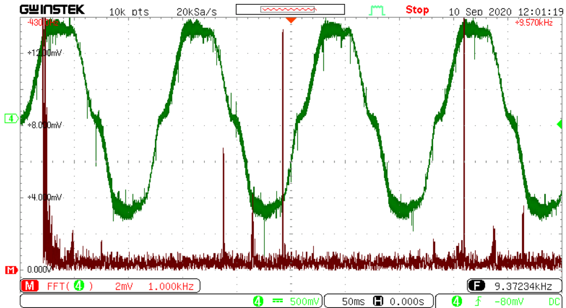
Figure III.31: le courant d'une phase et son FFT.
