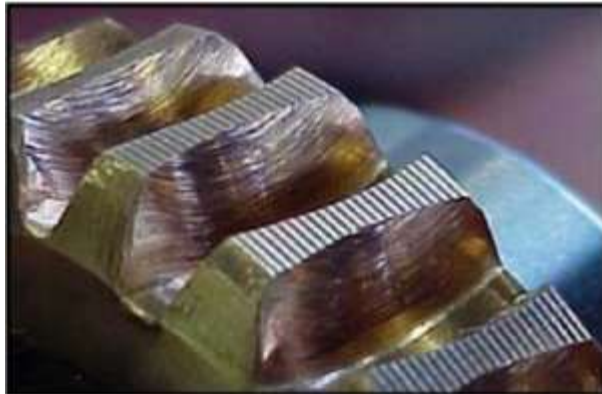
Figure2. 1: Surface usée d'une roue [jbil.17]
