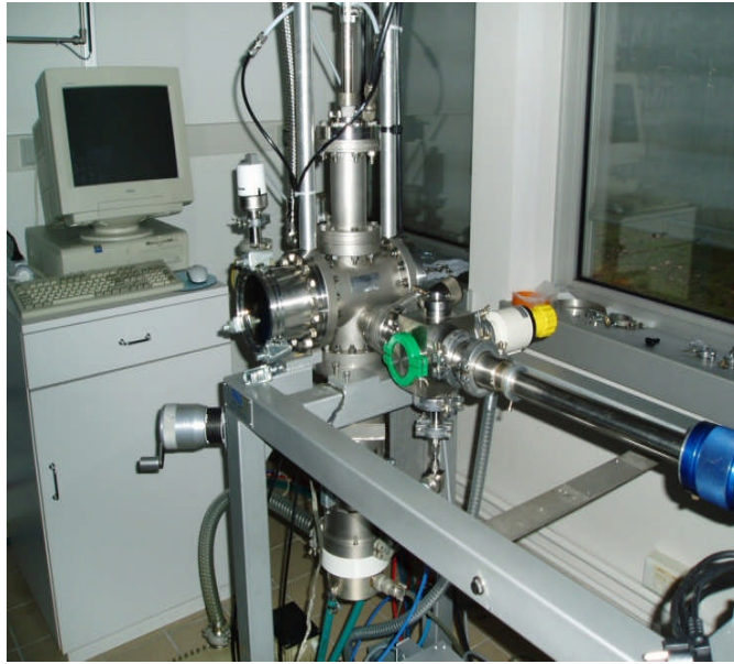
Figure III-1 Photo de l'ensemble du réacteur utilisé pour déposer les films minces de NiO.
