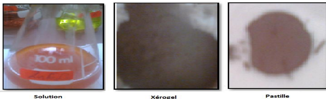
Figure III.3 : Solution de ferrite de Zinc obtenu à partir de la méthode sol gel.
