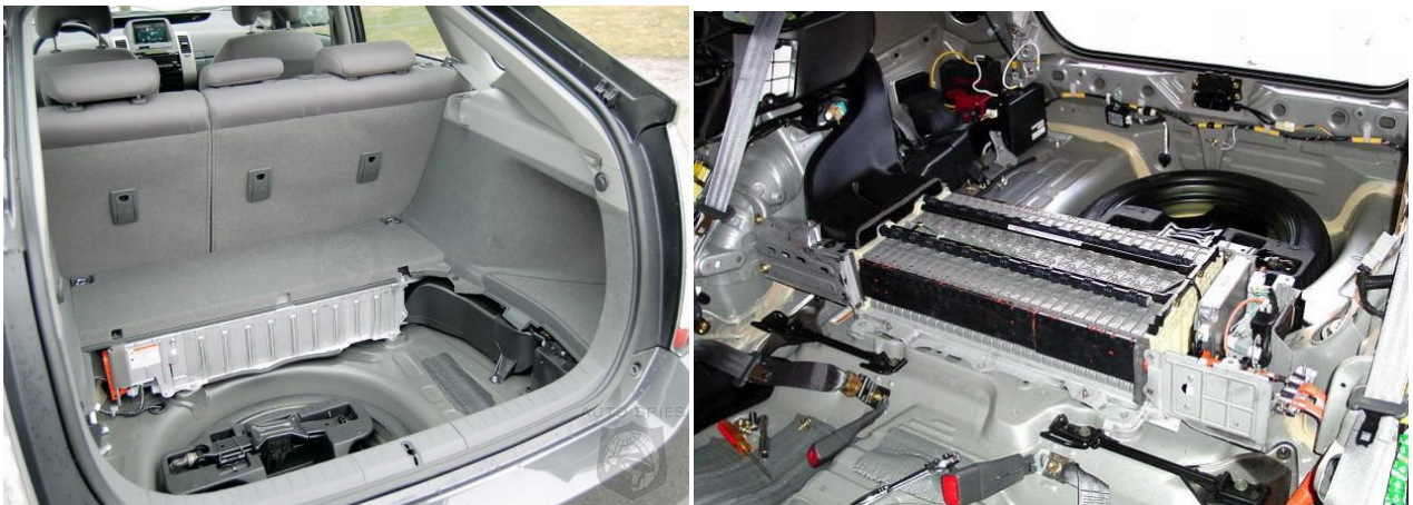
Figure II.4: Emplacement de la batterie dans la Toyota Prius
