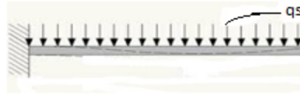
Figure IV. 19 : Schéma statique de la console
