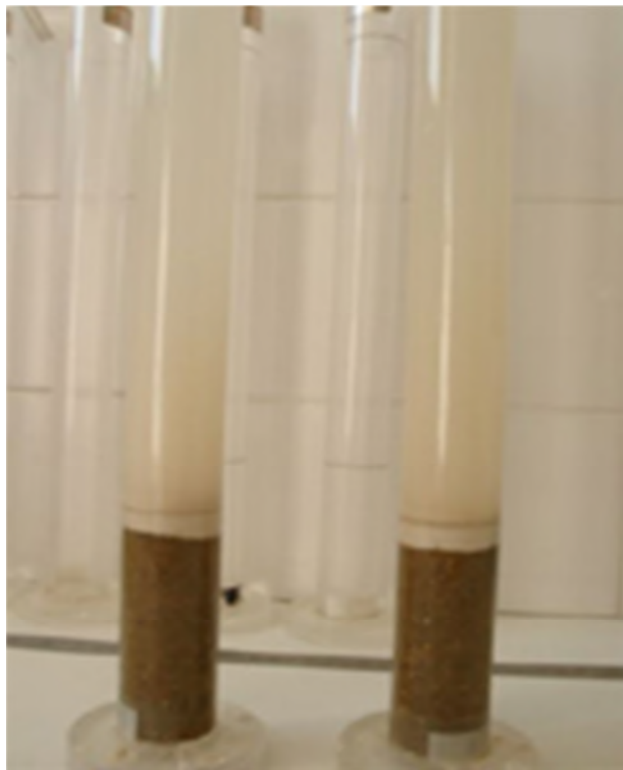
Figure 2.3. La masse volumique absolue (d'éprouvette graduée)
