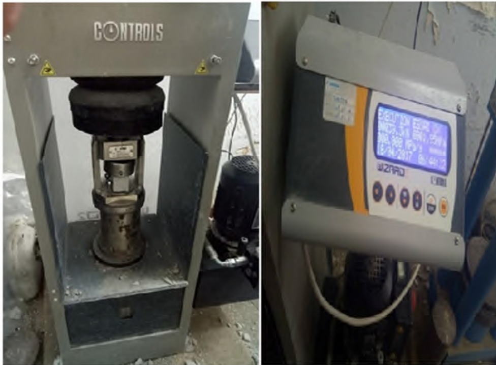
Figure 39. L'essai de compression.
