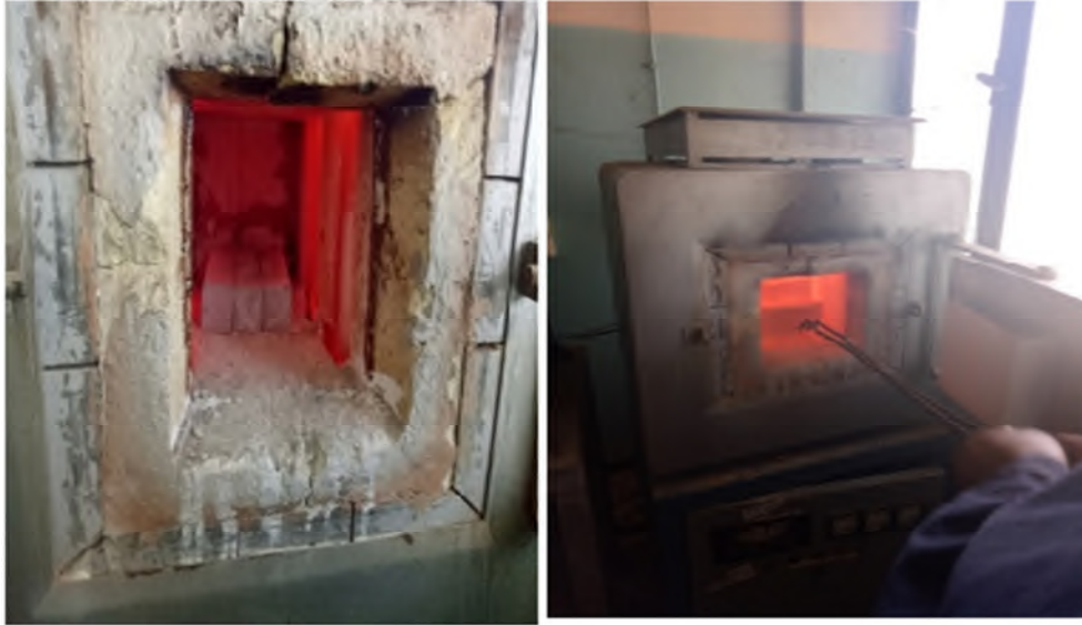
Figure 3.10. Chauffage du four a 1100 °C.
