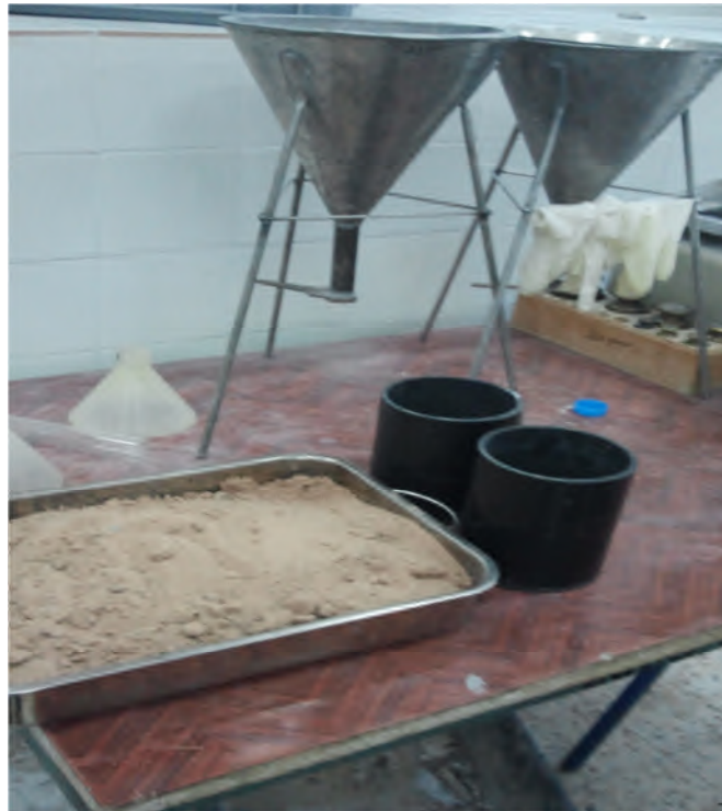
Figure 2.4. Essai de la masse volumique apparente.
