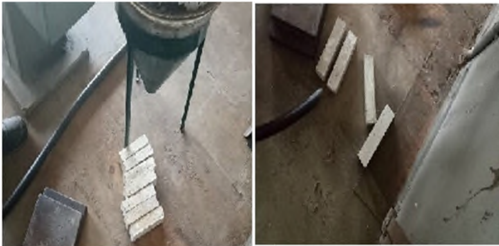
Figure 3.11. Éprouvettes ayant subi un traitement thermique puis refroidi.
