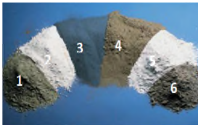
Figure 1.6. Différents ajouts cimentaires (Avec: 1: cendre volante classe C, 2: métakaolin, 3: fumée de silice, 4: cendre volante classe F, 5: laitier, 6: schiste. [1])
