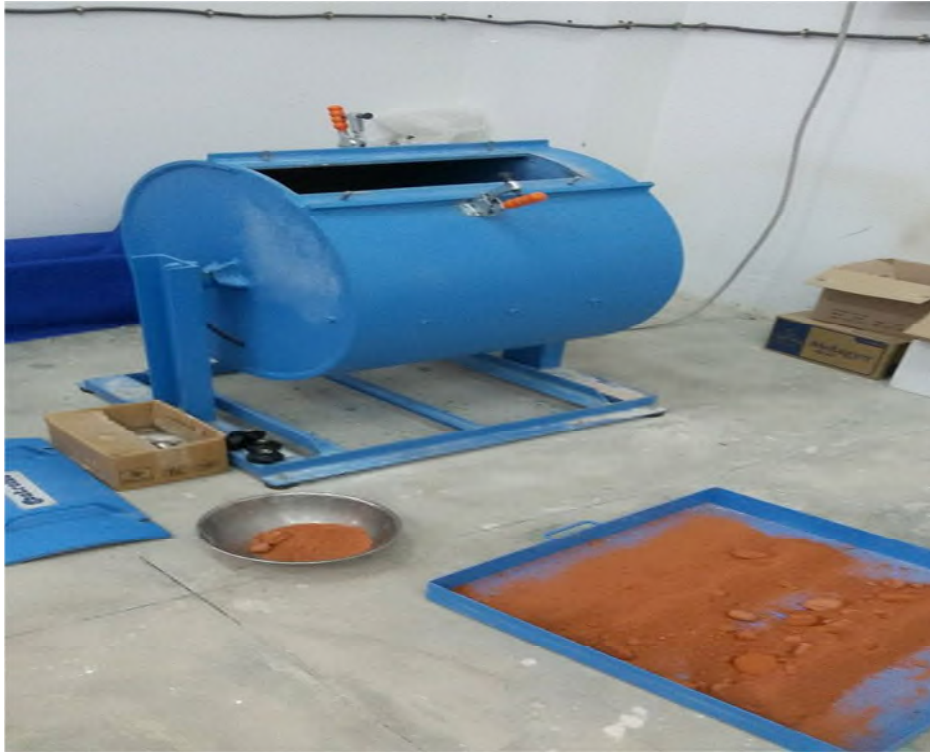
Figure 2.11. Broyage de la chamotte dans la machine Los Angeles.
