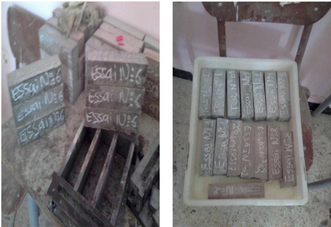
Figure 3.5. Le démoulage des éprouvettes et la Conservation des éprouvettes.
