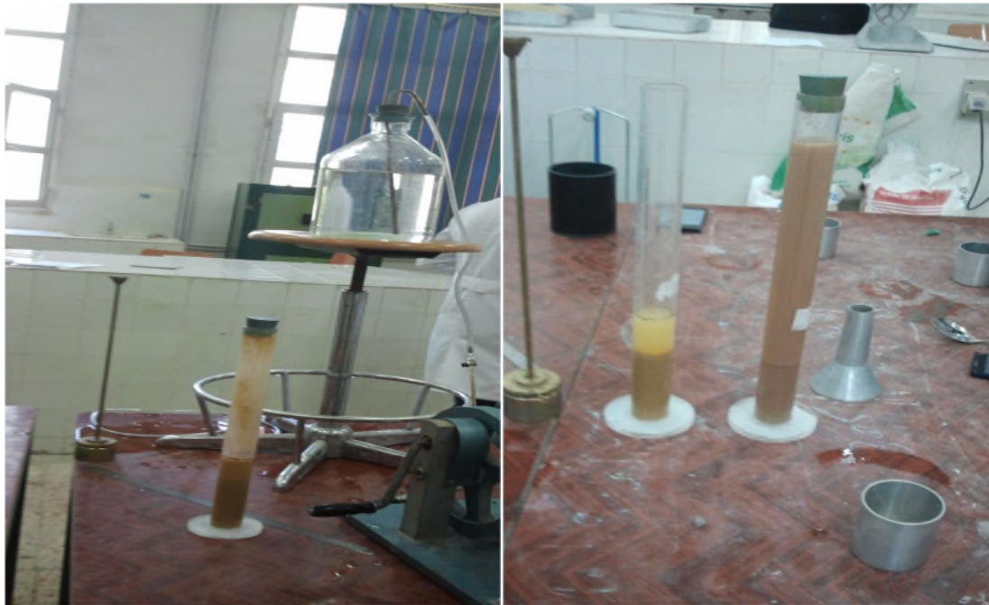
Figure 2.6. Essai d'équivalent de sable
