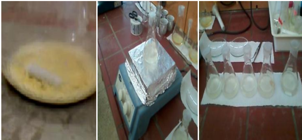
Figure II.3. Solutions d'oxyde d'étains obtenus à partir du \text{SnCl}_2 \cdot 2\text{H}_2\text{O}
