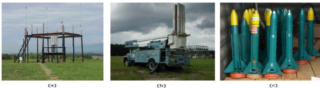
Figure I. 4: Equipements expérimentaux utilisés lors d'un déclenchement artificiel de la foudre (a) Lanceur fixe, (b) lanceur mobile, (c) fusées. [13]
