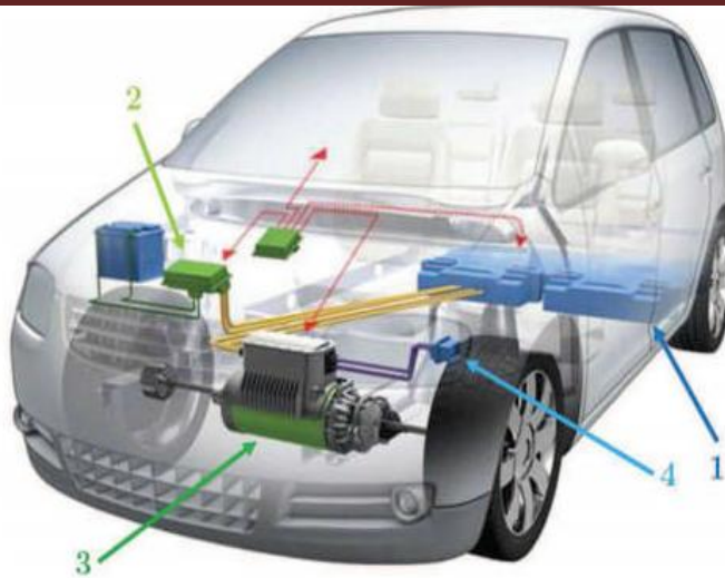
Figure I.1 : Composants Principaux du VE : 1 ) Batterie, 2) Onduleur/Chargeur,3) Moteur 4)Prise de charge
