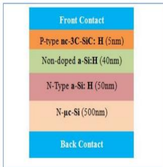
Figure 2-6 : Structure de la cellule solaire en nc-3C- SiC:H [37].
