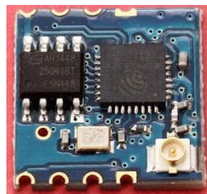
Figure 1.6 Cas d'un module de communication wifi
