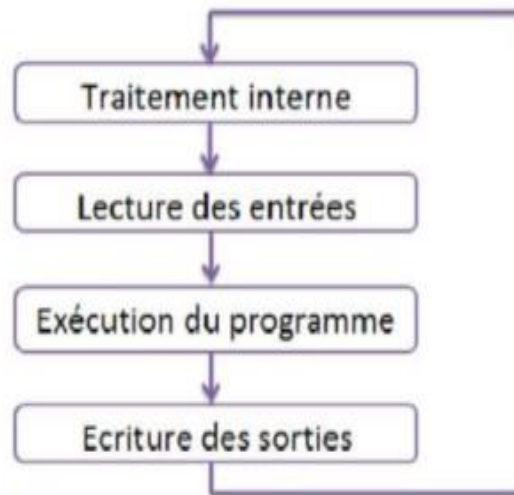
Figure I.4: Fonctionnement d'un API.
