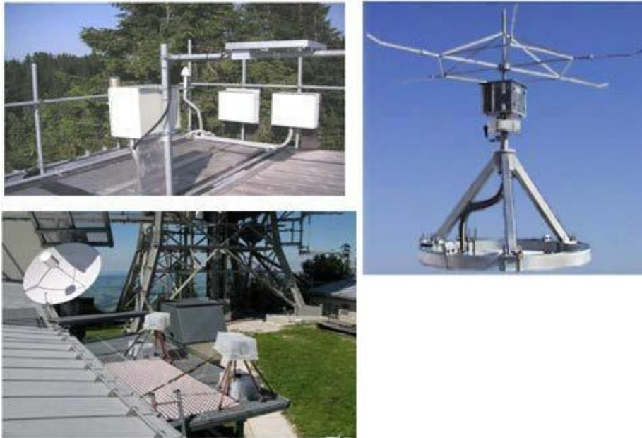
Figure I.17 Les équipements installés pour la mesure du courant de foudre et le champ électromagnétique associé [24]
