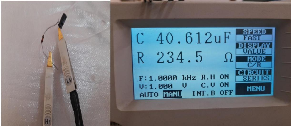
**Figure III- 14 :** Test de mesure d'un circuit série CR dans l'ISTEK LCR.
