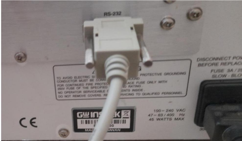
Figure III- 2 : la liaison entre LCR et câble RS232
