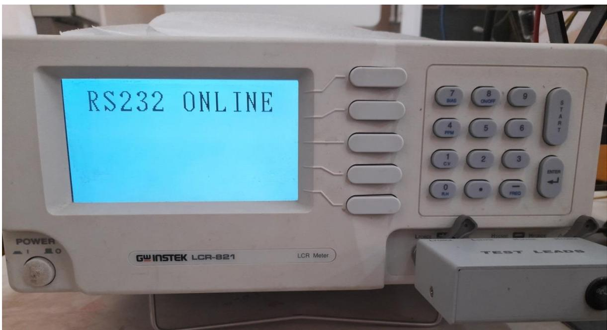
Figure III- 7 : Une image montrant l'appareil dans le mode "ONLINE"
