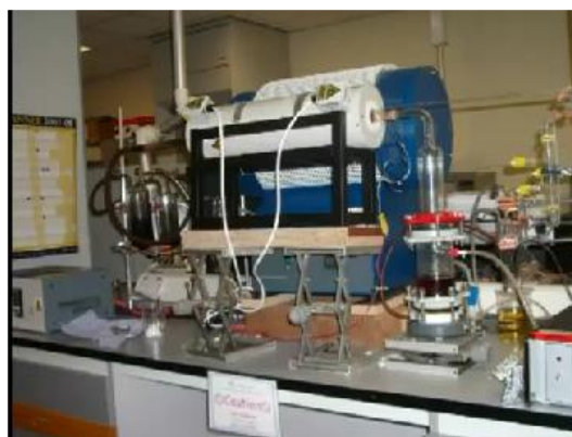
Figure I.15 : Schéma d'un réacteur CVD pour la croissance des (NTC) [Gohier 2007].
