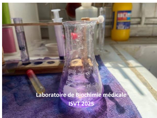
Figure 46: Un flacon Erlenmeyer a été utilisé pour la dilution du colorant May-Grünwald-Giemsa (MGG) au 1/10^6 .
