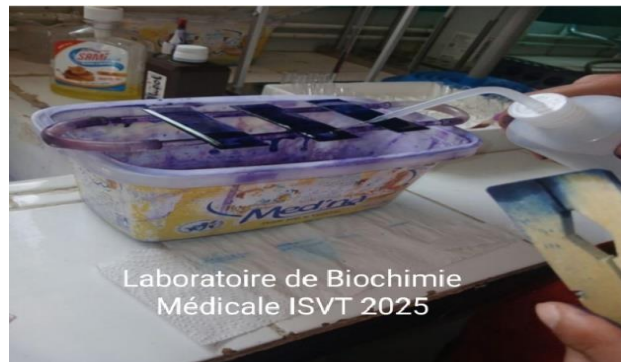
Figure64. La lame rincée délicatement à l'eau distillée afin d'éliminer l'excès de colorant.
