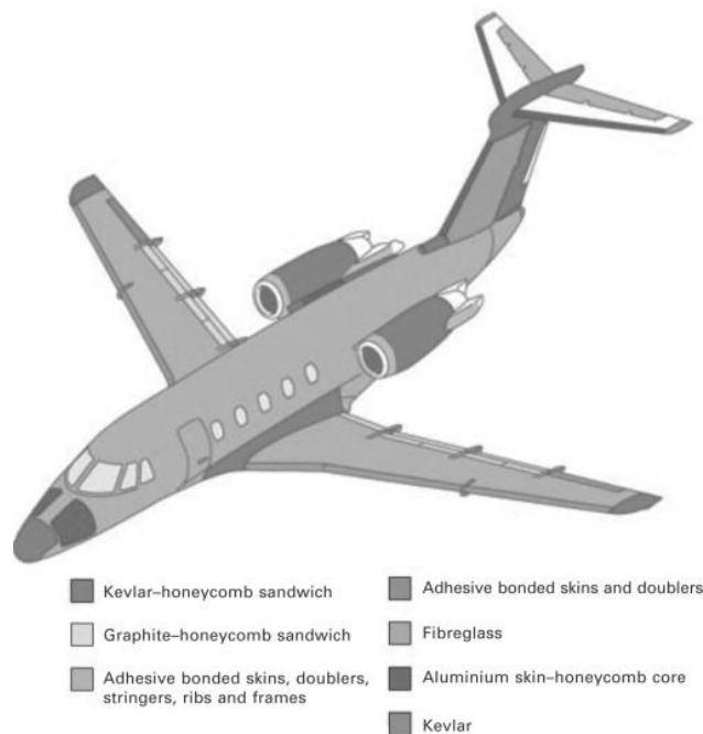
Figure.2.4..Montre l'application de composites sandwich collés à l'aide d'un avion [24]
