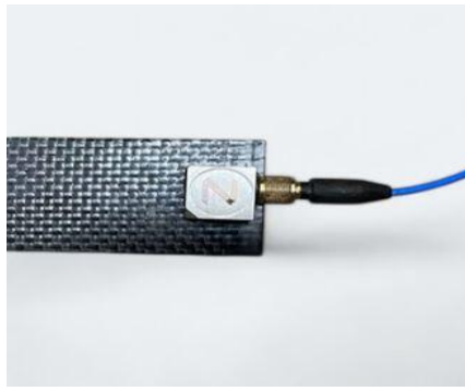
Figure III.5 : Positionnement de capteur d'accélération
