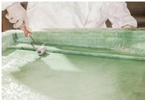
Figure I.14 Principe du moulage au contact.
