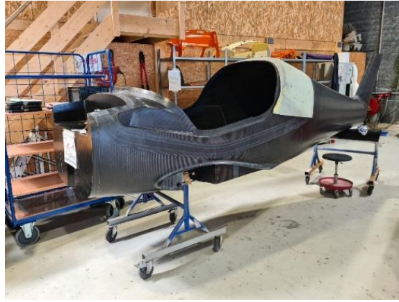
Figure I.11 Premier avion avec une structure toute en carbone
