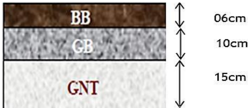
Figure 21. Dimensionnement par la Méthode CBR
