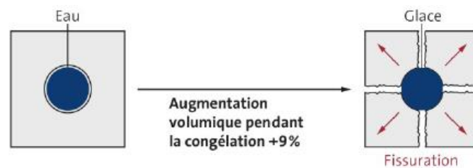
Figure I. 6 : Effet de l'augmentation de volume lors de la congélation de l'eau.
