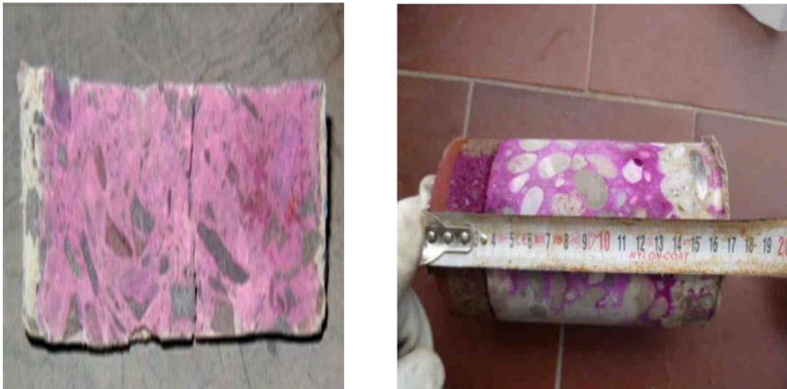
Figure I.7: Phénomène de la carbonatation.
