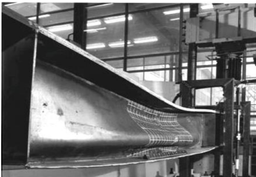
Figure I.9 : Voilement de l'âme d'une poutre
