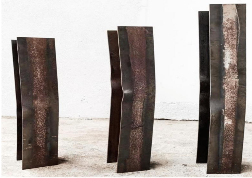
Figure I.4 : Instabilité combinée (flambement global et local).
