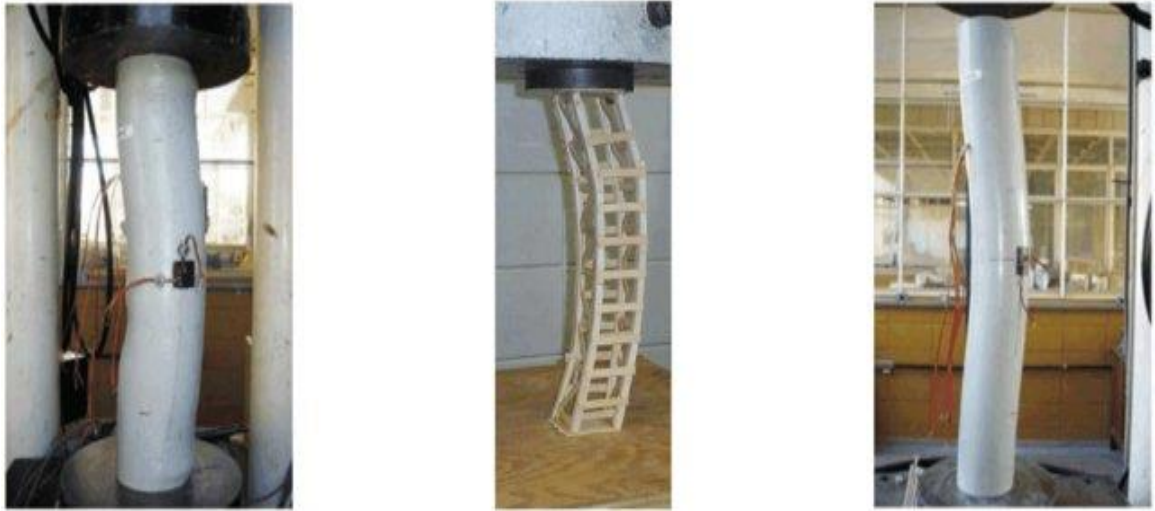
Figure I.2 : Flambement axial des colonnes.
