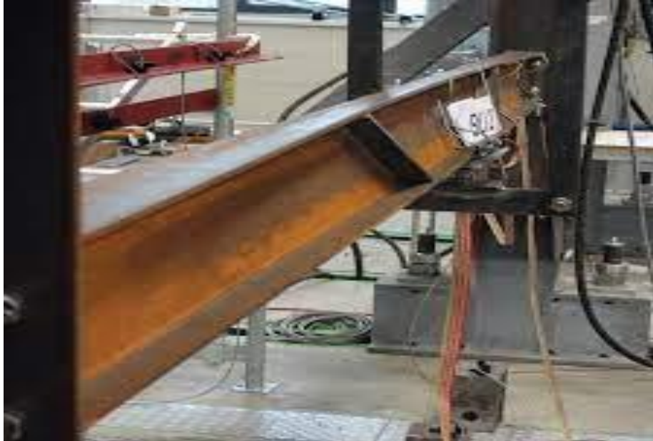
Figure I.3 : Déversement par torsion d'une poutre.
