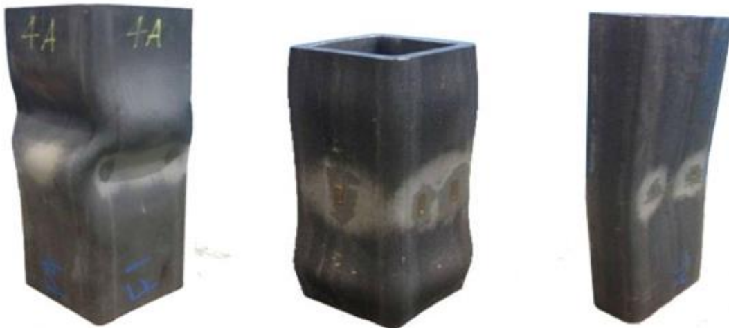
Figure I.1 : Flambement local des éléments tubulaires.
