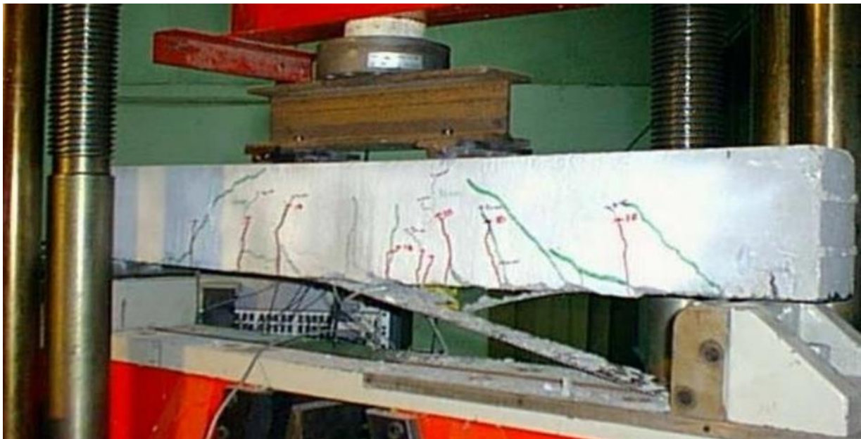
Figure III.6 : Rupture d'une poutre renforcée par décollement du renfort (BOUACHRIA and KARI, 2021)
