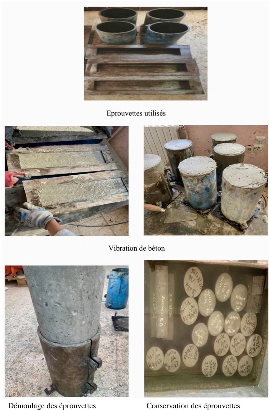
Figure .IV.18. Fabrication des éprouvettes de béton
