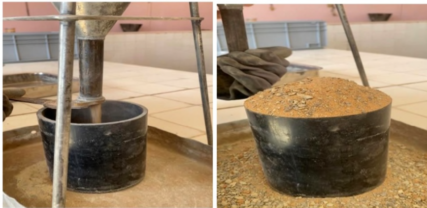
Remplissage du moule avec le sable
