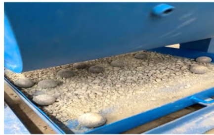
état de gravie après l'essai
