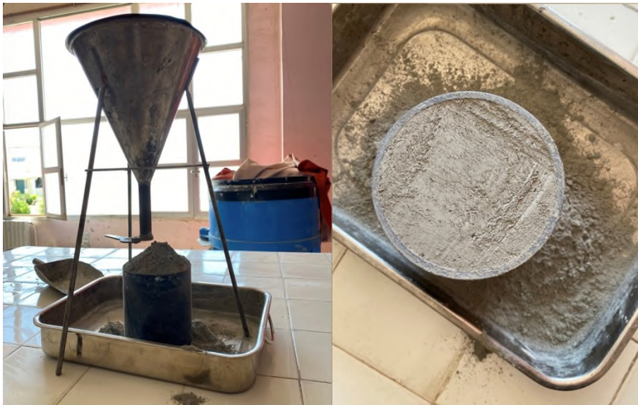
Figure .IV.12. Détermination de la masse volumique apparente de ciment
